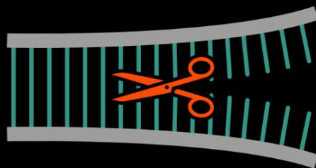
Velluto Iris относится к «разрезным» велюрам. Такие велюры ткут двумя параллельными полотнами, с последующим их разрезанием вдоль нитей основы.
